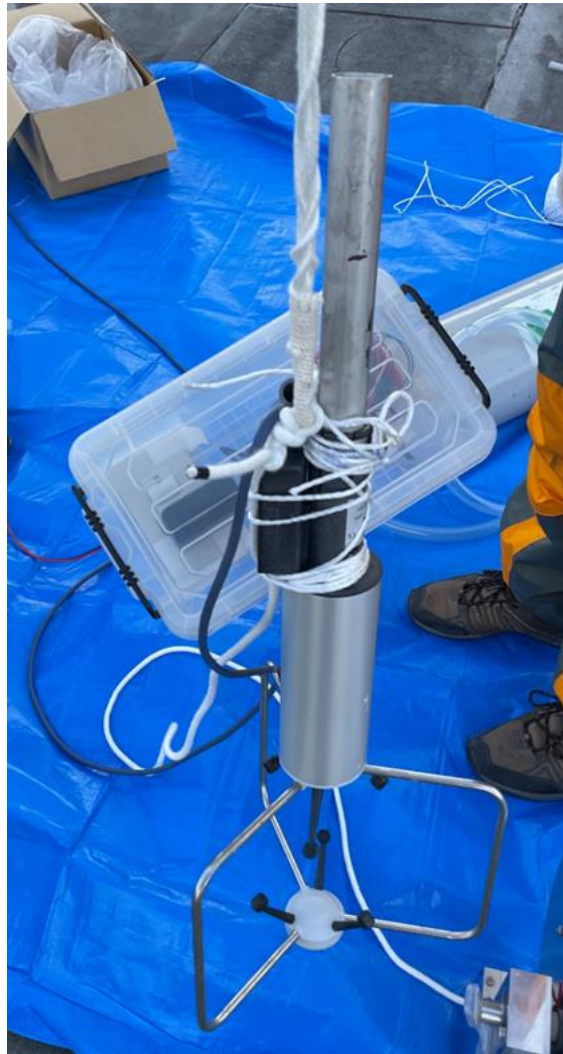
図 2.28 風速計-IMU センサー固定方法
